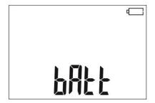
Pilas/baterías casi descargadas. El medidor se apaga automáticamente.
