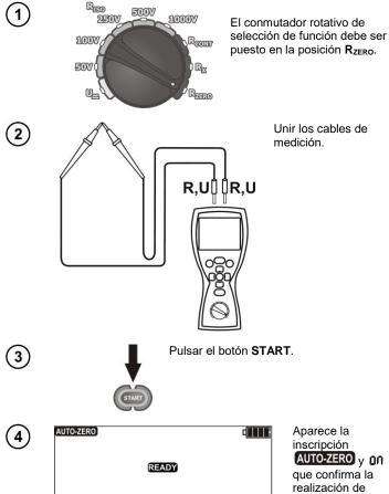
realización de compensación de resistencia en los cables de medición.
